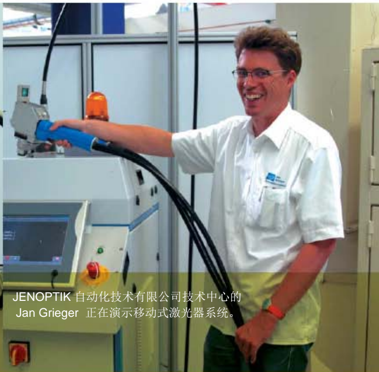
JENOPTIK 自动化技术有限公司用于手动焊接和钎焊的移动式激光器系统的焊接质量可以与机械或机器人控制的激光焊接相媲美。
