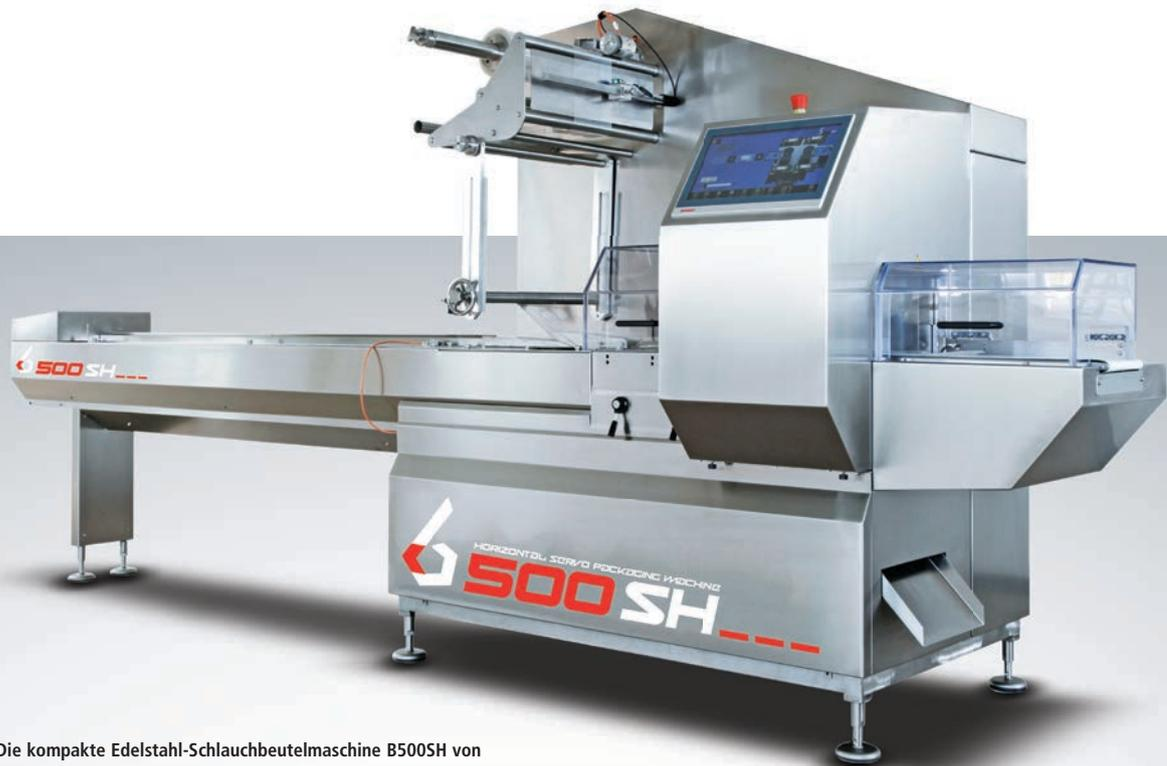
Die kompakte Edelstahl-Schlauchbeutelmaschine B500SH von Bauer Steuerungstechnik ist auch für den Nassbereich geeignet.
