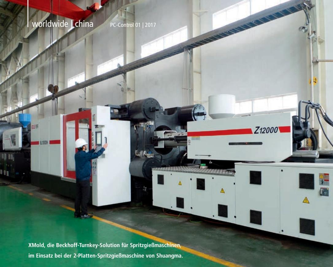
XMold, die Beckhoff-Turnkey-Solution für Spritzgießmaschinen, im Einsatz bei der 2-Platten-Spritzgießmaschine von Shuangma.
