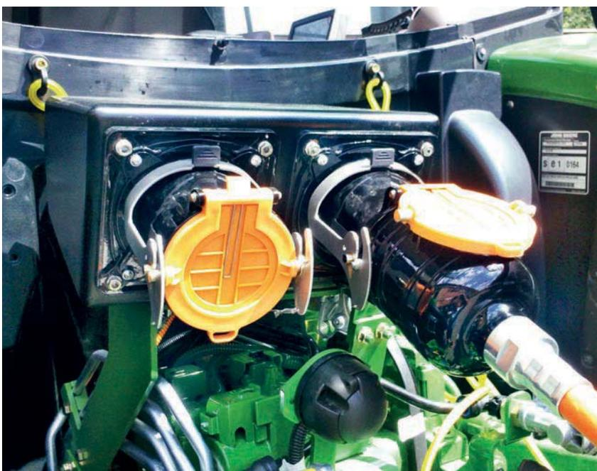
**Schnittstelle mit einseitig gesteckter Anschlussleitung zum Anbaugerät**
