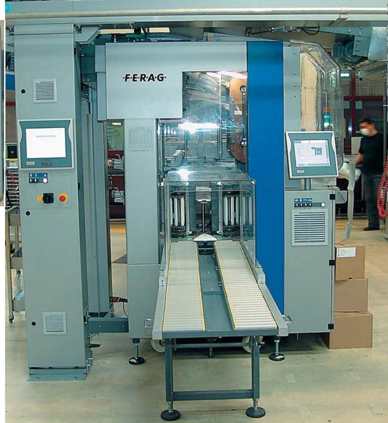
Als Bedienterminals sind die Beckhoff Control Panel CP77xx und CP69xx im Einsatz, die in kundenspezifischer Ausführung für Ferag gefertigt werden. Die Panel-PC-Variante CP62xx wird ebenfalls eingesetzt.
